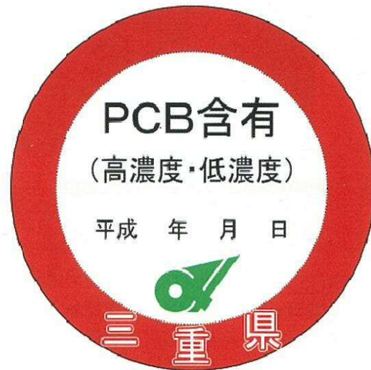
<識別シール（赤色）> PCB廃棄物であることを示しています。
