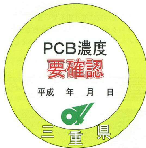
<識別シール（黄色）> PCB濃度が不明で、濃度確認が必要であることを示しています。
